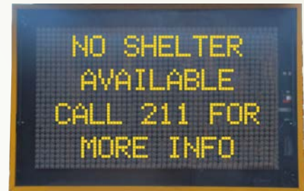
LA DOTD sử dụng Ký Hiệu Nhấn Tin Tùy Chỉnh (VMS) để gửi tin nhắn đến tài xế.
